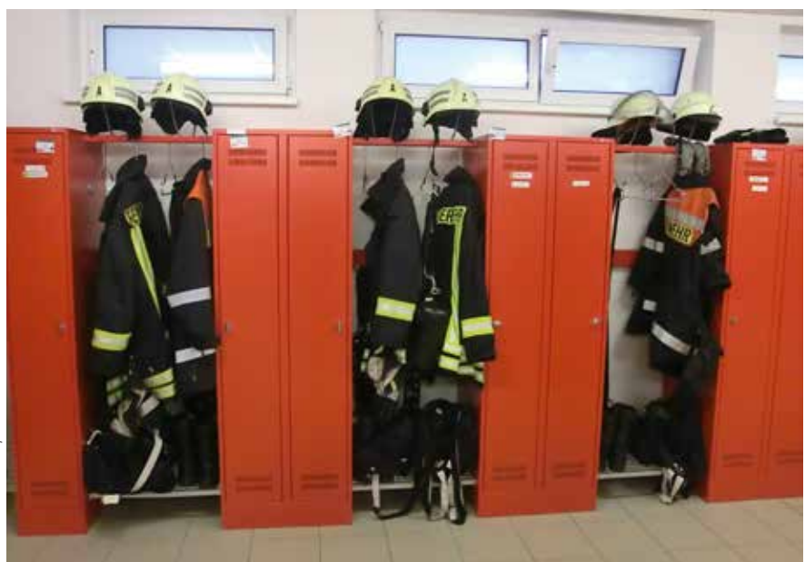
► Spindel mit der Möglichkeit zur Schwarz-Weiß-Trennung durch Ablegen der PSA im offenen Teil und der privaten Sachen im Spindelteil daneben
