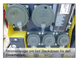
Ein genormter Stromerzeuger der Feuerwehr mit normalem IT-Netz eignet sich nicht dazu, Strom in das Leitungsnetz von Gebäuden einzuspeisen. Dafür braucht es spezielle Stromerzeuger und Vorbereitungen im Gebäude.
