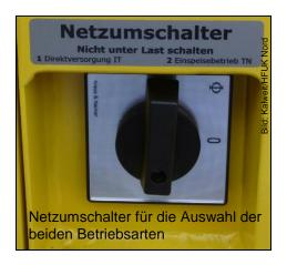
In Schalterstellung 2 wird die **Betriebsart "Einspeisebetrieb"** gewählt. Dadurch wird die Netzform TN-S System gewählt. Das bedeutet, dass eine Direktversorgung von an den Stromerzeuger angeschlossenen Einsatzgeräten nicht mehr möglich ist, da die Steckdosen allesamt abgeschaltet werden und nur noch eine spezielle Steckdose (5-polige CEE-Steckdose 400 V/1h, IP 67) in grauer Farbe mit 1 Uhr-Stellung betrieben wird.
